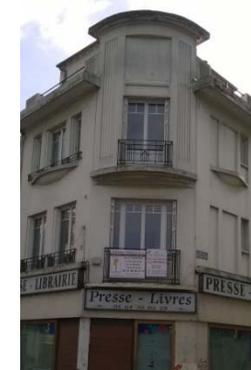
La présence d'éléments architectoniques en saillie ou de balcon rend l'isolation thermique par l'extérieur inopérante.
