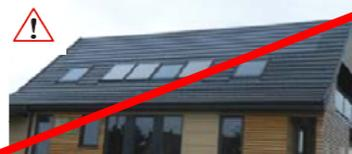
A éviter la dispersion d'éléments de hauteur différente sur la toiture
